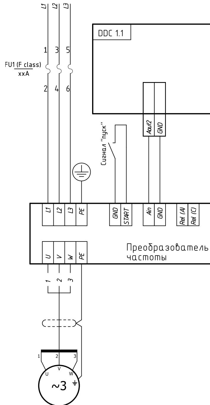
**Подключение преобразователя частоты.**
