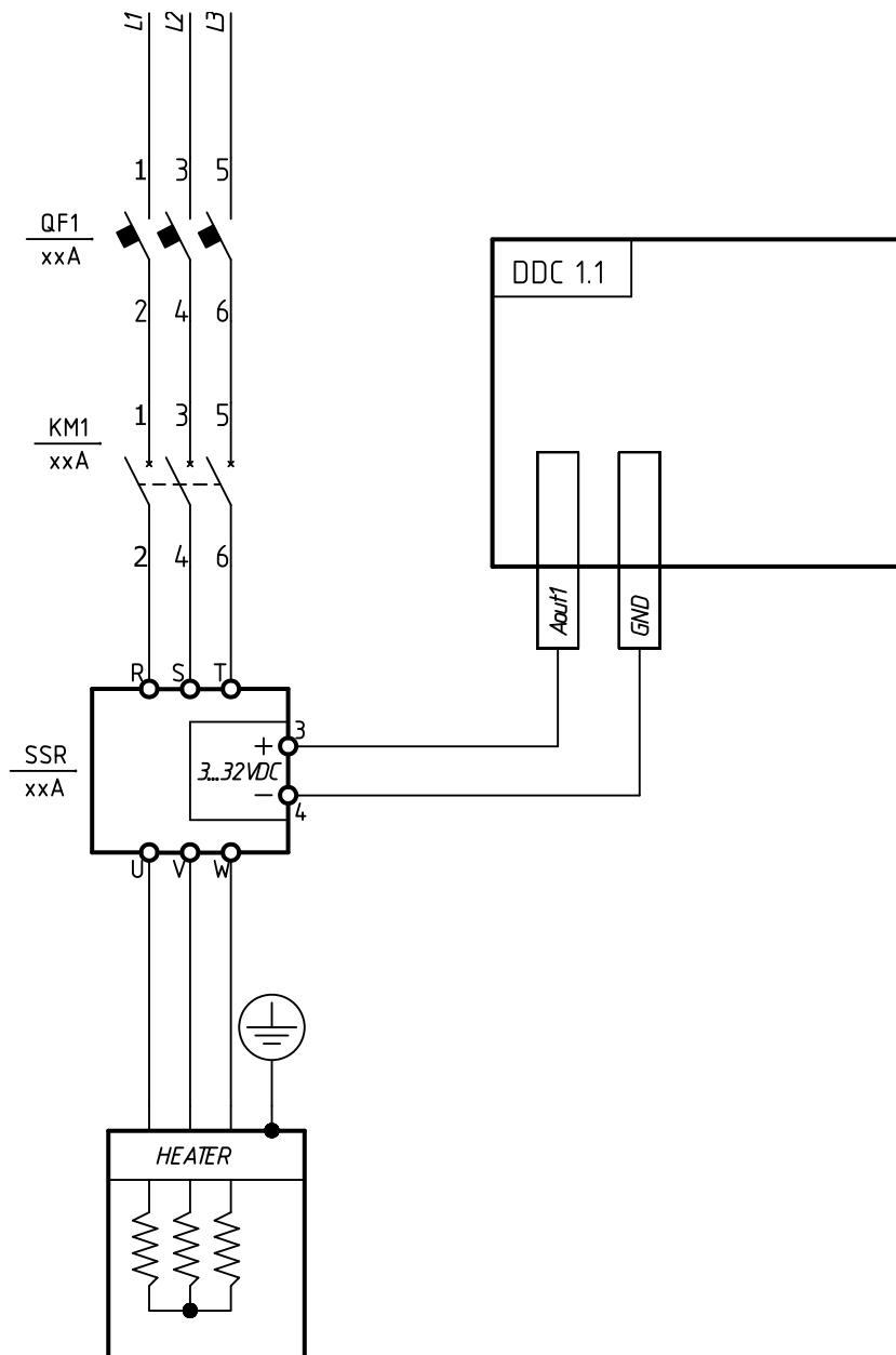
Выходы Aout1, Aout2 и Aout3 могут быть настроены как для работы в режиме ШИМ, так и в пропорциональном режиме. Настройки каждого выхода независимые.
